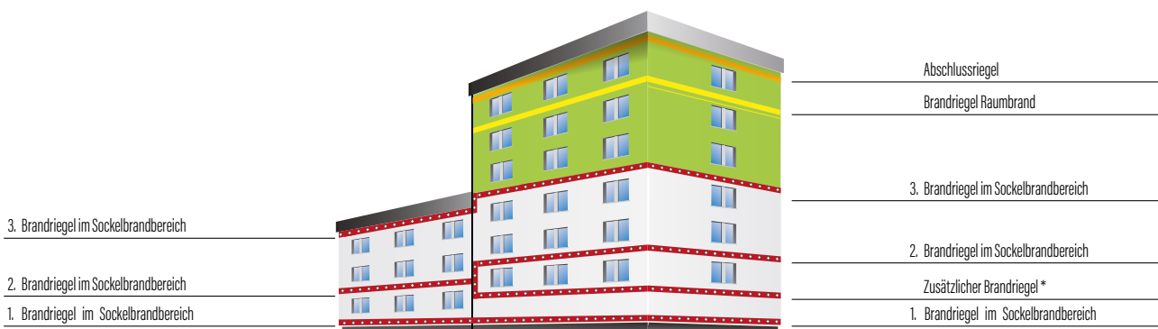
Abbildung 55: Beispielhafte Ausführung von Brandriegeln bei gleicher (oben) oder unterschiedlicher Höhenlage der Geschosse (unten). In der Schutzzone Sockelbrand ist zur Einhaltung der Maximalabstände gegebenenfalls ein weiterer Riegel anzuordnen.
