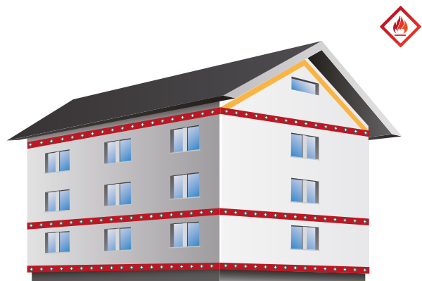
Abbildung 44: 3. Brandriegel in Doppelfunktion auch als Abschlussriegel
