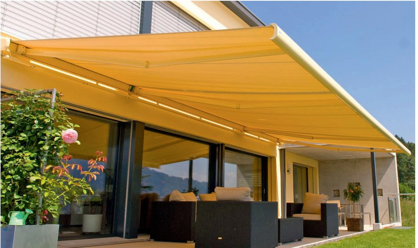
Die Konsolen der Markisen werden aus ästhetischen Anforderungen oft eher klein und filigran gestaltet. Dies verursacht grosse Belastungen, welche in den Untergrund eingeleitet werden müssen. Bei gedämmten Fassaden kommt zusätzlich die Anforderung an eine wärmebrückenfreie Anbindung dazu.
