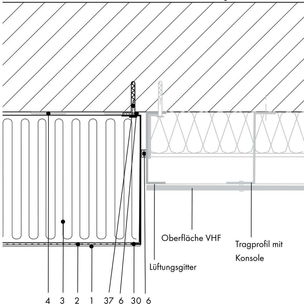
Der Anschlussbereich zwischen WDVS und VHF kann mit Mineralwolle geschlossen werden um eventuelle Wärmebrücken zu minimieren.
