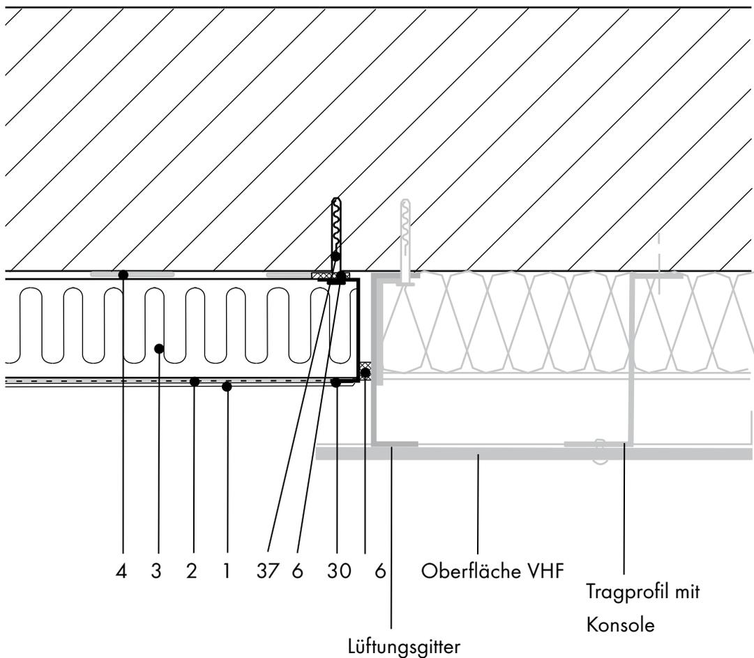
Der Anschlussbereich zwischen WDVS und VHF kann mit Mineralwolle geschlossen werden um eventuelle Wärmebrücken zu minimieren.
