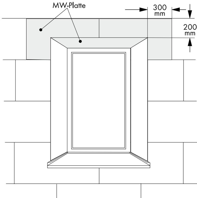
Oberhalb der Fassadenöffnung und bei Dämmung der horizontalen Laibungen im Sturzbereich ist ein Streifen aus Mineralwolle vollflächig zu verkleben und zu verdübeln, Abmessungen siehe Zeichnung.
