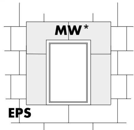
\* Bei der Montage von Fenstern in der Dämmstoffebene müssen diese dreiseitig von einem mindestens 20 cm breiten bzw. hohen nichtbrennbaren Mineralfaser-Dämmstreifen (Klasse A1 oder A2-s1,d0 nach DIN EN 13501-1) umschlossen sein, der vollflächig zu verkleben und ggf. zu dübeln ist.
