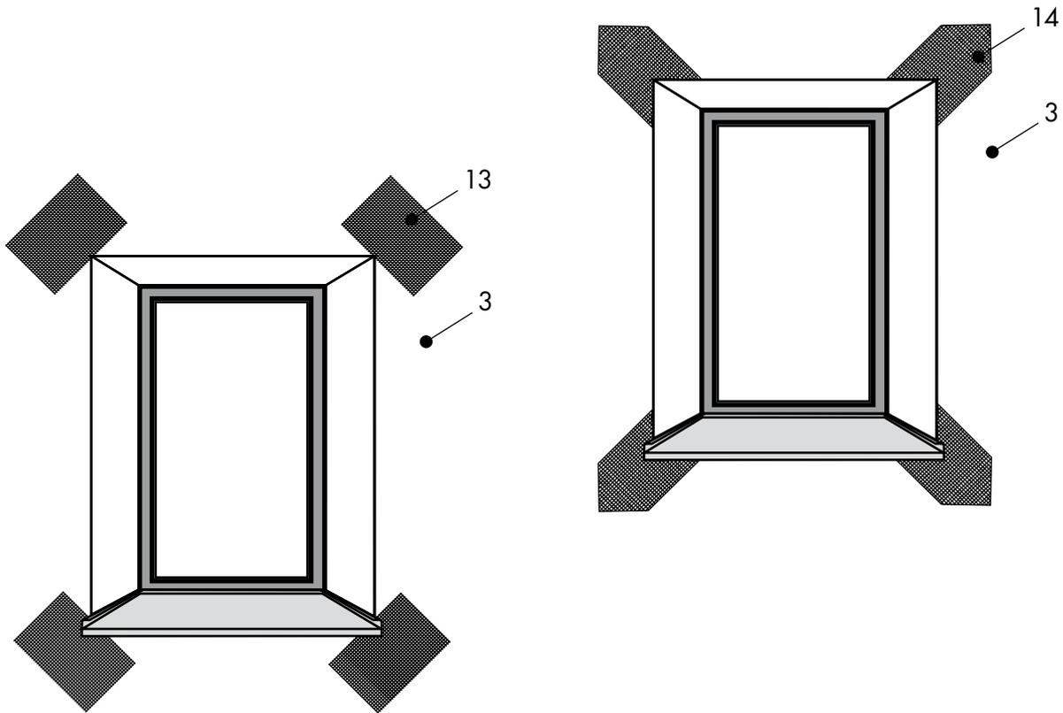
Die Diagonalarmierung muss mindestens 30 cm lang und mindestens 20 cm breit sein. Einsatz an allen Ecken von Gebäudeöffnungen.
