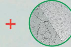
A FILLING COAT CAN BE MIXED DIRECTLY ON-SITE ACCORDING TO THE INDIVIDUAL SITUATION BY THE VARIABLE ADDITION OF KEIM CONTACT-PLUS (MAXIMUM MIXING RATIO 1:1).
