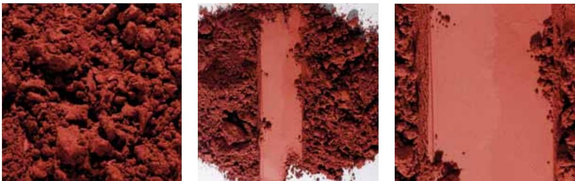
Zwei Pulverabmischungen desselben Farbtons – die linke Hälfte mit und die rechte ohne Titandioxid. Das lose Pulver zeigt optisch keinen Farbunterschied. Im glatt gedrückten Zustand zeigt sich die stärkere Leuchtkraft der titandioxidfreien Mischung.
