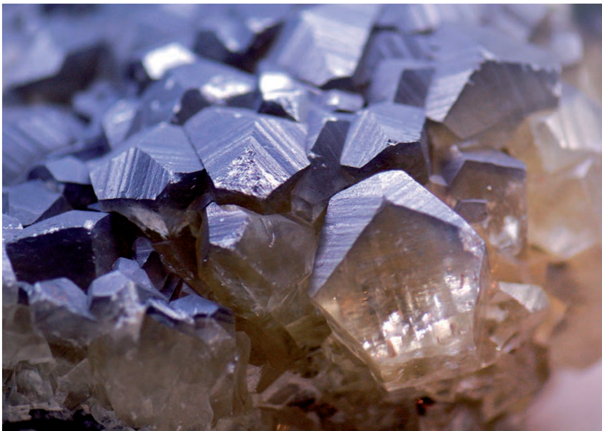
Il quarzo - base per il legante al silicato di potassio o l'acqua di vetro.
