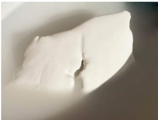
Industriell nassgelöschter und gelagerter Kalk: «Sumpfkalk»
