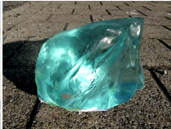
rechts: Wasserglasschmelze, eine Schmelze bestehend aus Quarzsand und Kaliumcarbonat
